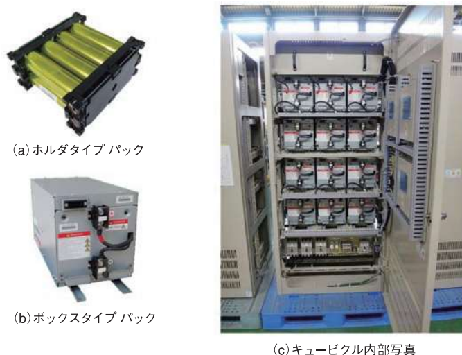
図8 開発したLCAPパック、およびキュービクルの例 Figure 8 Examples of developed LCAP packs and cubicle
