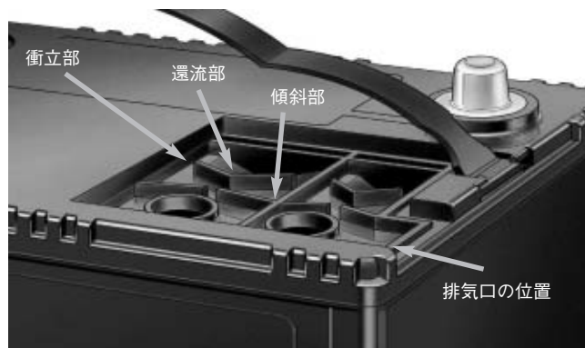
図11 無補水タイプバッテリーの還流部の構造 Fig.11 Special Lid Structure having Space for Water Return.
