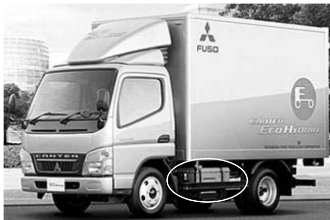
図10 電池システムの車両搭載場所 Fig.10 Mounting Position of Battery System on Delivery-Use Truck.
