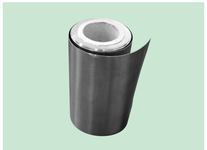
図3 0.2mm厚みの粉末圧延シート
